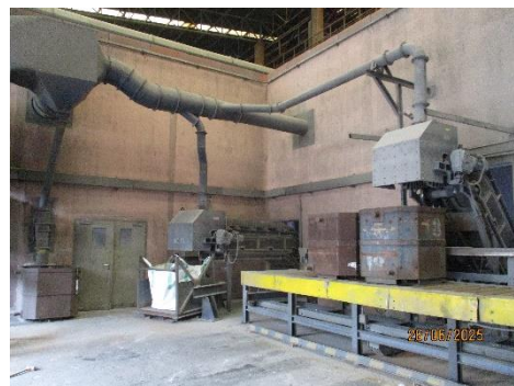
ภาพที่ 2-8 ห้องครอบเครื่องจักรพร้อมติดตั้งวัสดุดูดซับ
